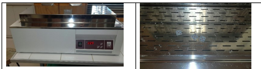
Figura 4. Imagen de medición ensayo absorción de agua.
